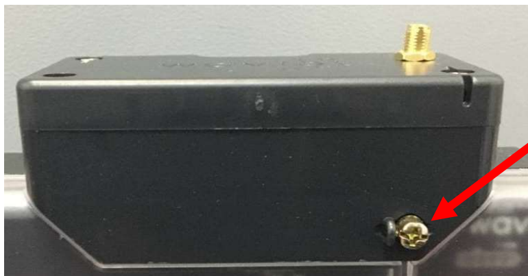
Рисунок 6.1 – винт крепления корпуса модуля связи
