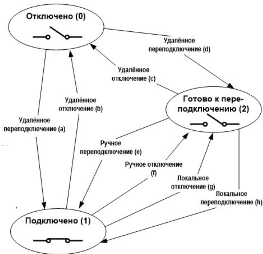
Рисунок 5.1 – Схема переходов состояний реле нагрузки.
