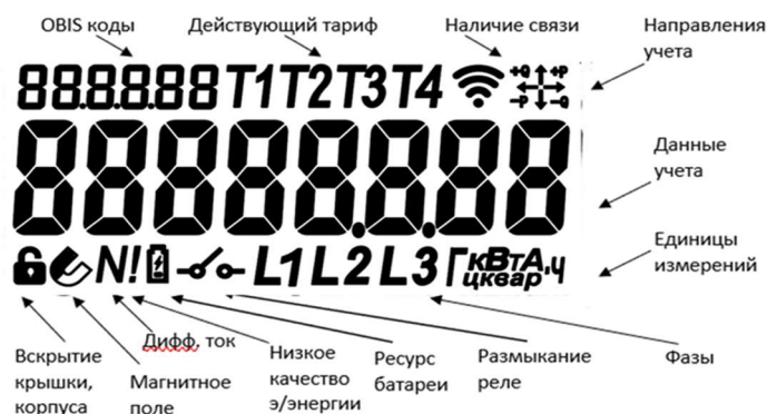
Рисунок 3.3 - Карта сегментов дисплея и их назначение
