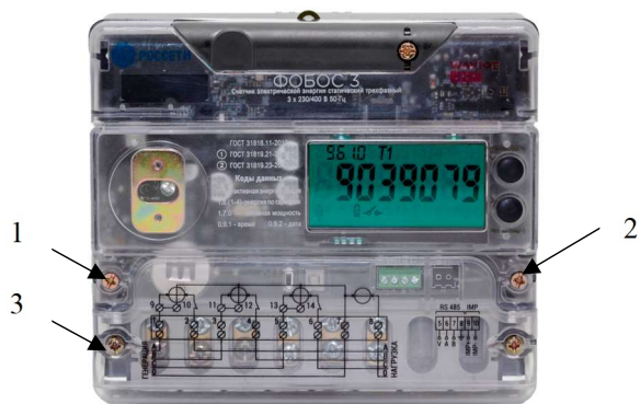
в) Счетчик ФОБОС 3 шкафного исполнения модели корпуса М(1)
