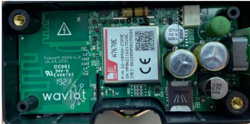
Рисунок 6.6 – Плата сменного модуля связи 2G/4G
